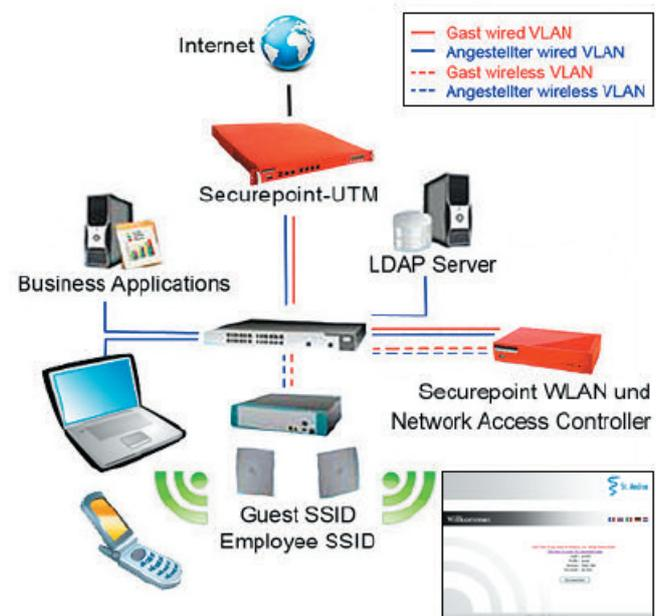
Der eingehende und ausgehende Datenverkehr läuft über die Securepoint Network Access Controller, um die absolute Daten- und Kommunikations-Sicherheit zu gewährleisten, LAN-Integration zu vereinfachen, Verwaltung zu erleichtern und die Benutzerfreundlichkeit im Netzwerk zu verbessern. Der Network Access Controller ist je nach Modell in der Lage, tausende Benutzer gleichzeitig zu handhaben.
